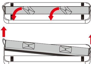
③ カートリッジから出ているバナー取付け幕 (両面テープ付) をバナー下端の裏面に位置を合わせてまっすぐ貼り付けます
