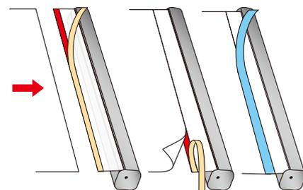
⑤ 必ずバナーの取付けが完了してからロックピンを外します (先に外すと元に戻せません)
