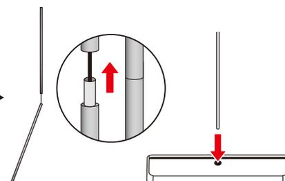
⑧ バナーをゆっくり引き出し、支柱先端に取り付けられている支柱固定キャップを上部バーの溝に引っ掛けます
