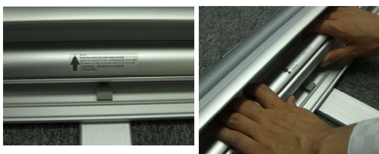
⑥ バネにある矢印の方向へ両手で20～25回転巻く (巻き過ぎるとバネに負担を与えるので注意する)
