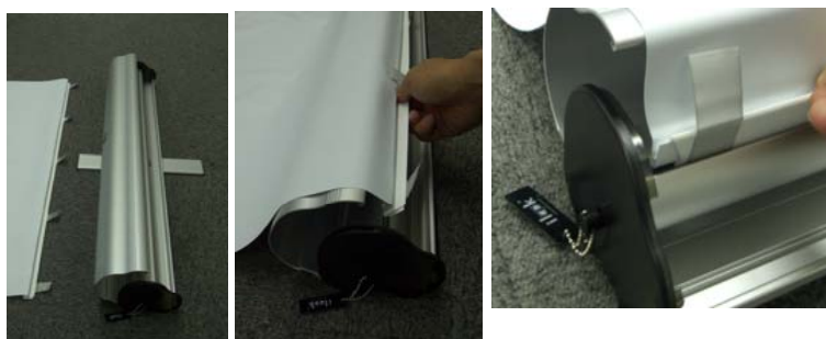
⑧ バナーを用意し、白いクリップを持ってバネのスリット部分に 差し込む(クリップの向きに注意する)
