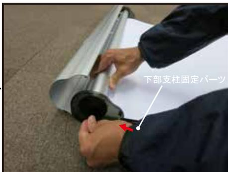
本体を抑えていた人は右手でロール部を持ち、巻戻してしまうのを止めながら本体左側の穴にロックピンを通してバネが戻るのを固定します。
