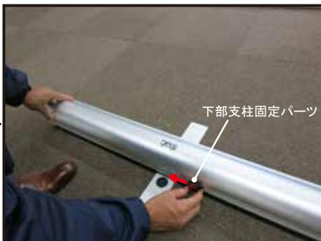
下部支柱固定パーツの位置がずれている場合は、本体のセンターに移動させ下部ブラケット(足)の穴の位置と合わせます。
