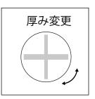
厚み13-20mm、幅160mm以内のスマートフォンを設置することができ、サイズ以内であれば縦置きでも横置きでも撮影が可能です。また、ホルダーを左右に回転させることで厚みの違うスマートフォンでもお使いいただけます。狭い溝にはケース型、広い溝には手帳カバー型を想定しています。(すべてのスマーフォンへの対応を保証するものではございません)
