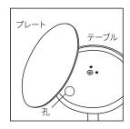
ホルダーが汚れてしまった場合やテーブルに水が溜まってしまった場合はホルダー+底プレートを取り外すことでメンテナンスが可能です。背面の孔から指で底プレートを押し出すことでホルダー+底プレートの取り外しが可能です。
